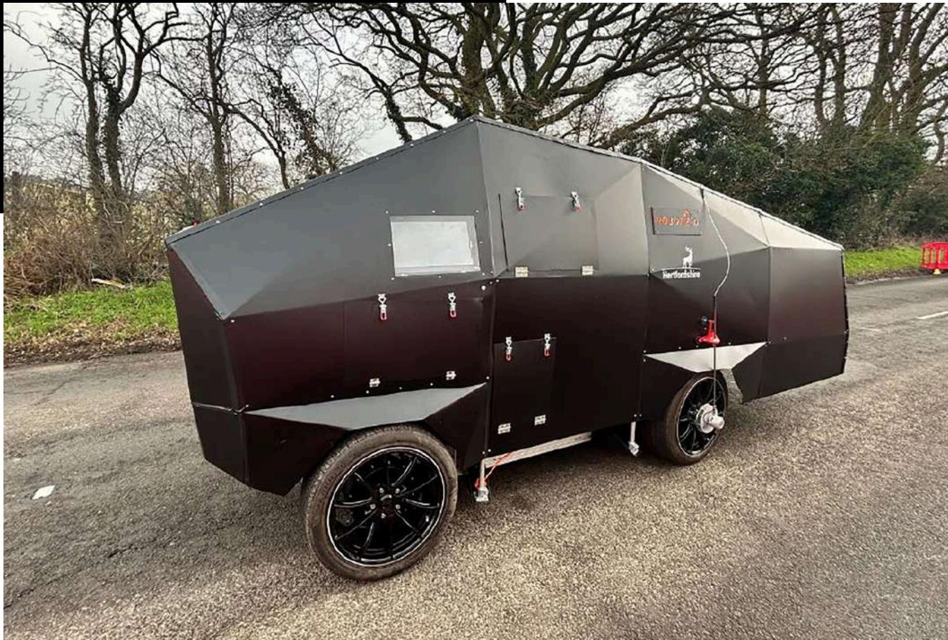
Robotiz3d Technology Ltd (spinout de la Universidad de Liverpool) presentó una solución robótica autónoma con IA para la detección y reparación automática de defectos en pavimentos y carreteras. La tecnología reduce la necesidad de intervención humana directa, acorta los tiempos de mantenimiento y mejora la seguridad para operarios y usuarios.
